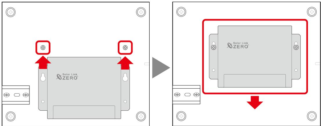
2. 同梱のネジで四隅を締め、ZERO を中板に固定します。
