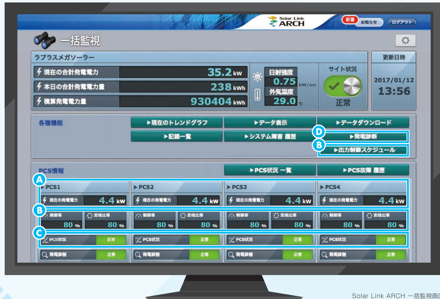
Solar Link ARCH 一括監視画面
