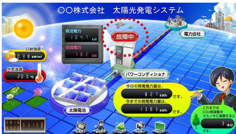
※複数台のパワーコンディショナを接続している場合は、いずれか1台から信号を受け取った時点で異常を知らせるアイコンが表示されます。
