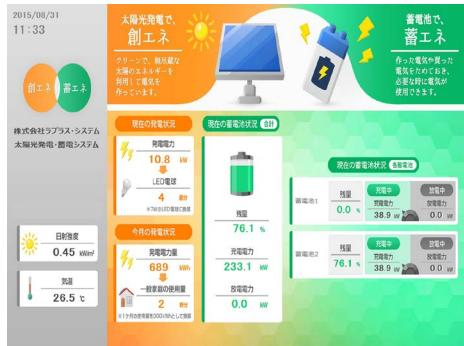
表示項目に蓄電池の情報(蓄電池の残量・充電電力・放電電力など)が追加されます。個々の蓄電池の状況を表示するパターンと蓄電池の合算値を表示するパターンと大きく2種類あります。上図は個々の蓄電池の状況を表示するパターンで、蓄電池が2台の場合の例です。
