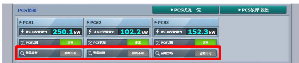
発電診断のステータスが「診断不可」の画面例
