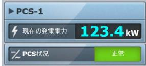
← PCS 毎の現在の発電電力が表示されます [最大 3 桁+小数 1 桁]。
