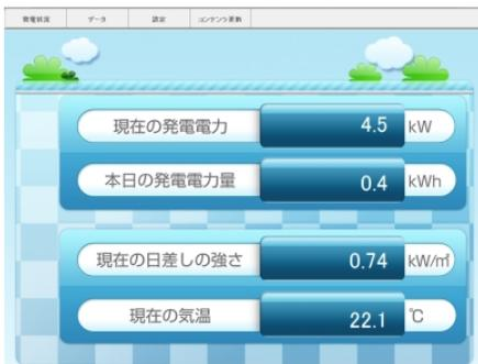
Solar Link ZERO が計測したデータを Web ブラウザ (Internet Explorer) 上で表示します。
