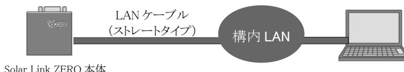
※ネットワーク設定を行うために、Solar Link ZERO に IP アドレスなどを割り振る必要があります。設置場所のネットワーク管理者様に相談して、下記情報を取得してください。
