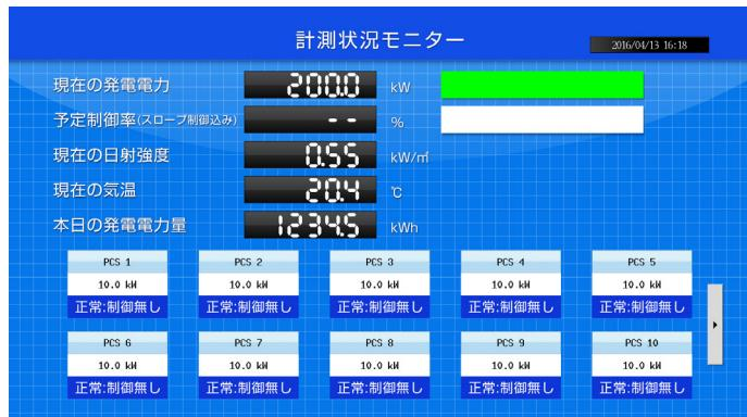
※計測機器毎の情報は1画面につき最大10台表示されます。画面右端の矢印ボタンをクリックすることで、次の10台を表示できます。
