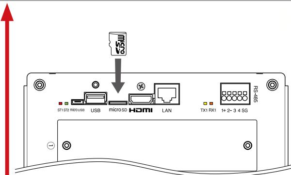
ZERO 本体に挿入されている microSD カードが認識できない状態です。本体の microSD スロットに microSD カード挿入されているか、または、挿入されている場合でもしっかりと奥まで挿入されているかご確認ください。
