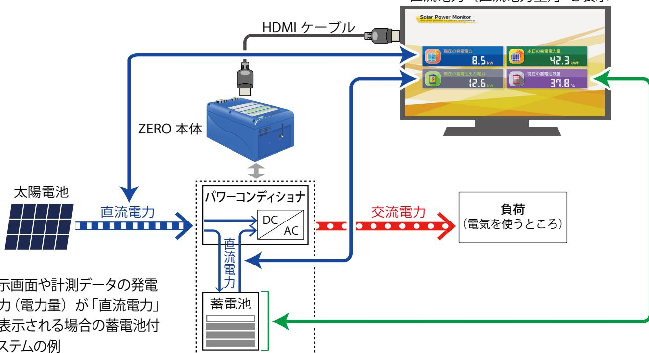
※表示画面や計測データの発電電力（電力量）が「直流電力」で表示される場合の蓄電池付システムの例
