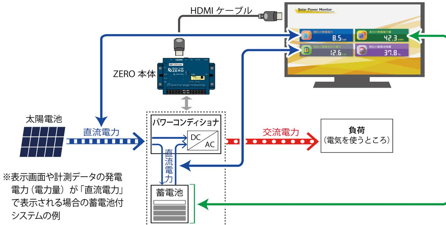
※表示画面や計測データの発電電力（電力量）が「直流電力」で表示される場合の蓄電池付システムの例
