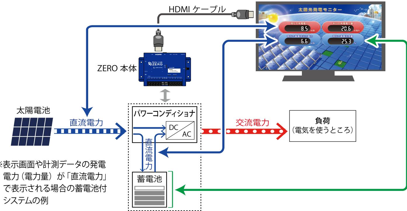
※表示画面や計測データの発電電力（電力量）が「直流電力」で表示される場合の蓄電池付システムの例
