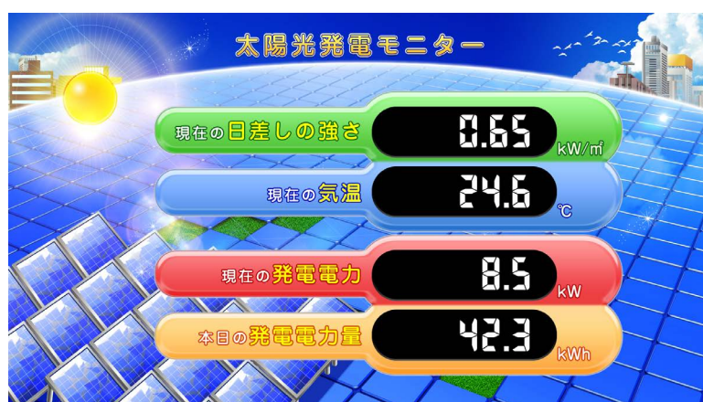
標準 A のデザインで日射計・気温計有の計測画面の例
