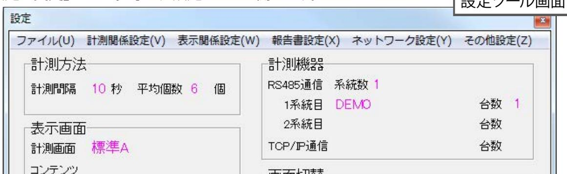
2. 計測機器の設定内容の確認や変更の後は、「4.2 設定の終了」 P.7 を参考に、計測を再開させます。
