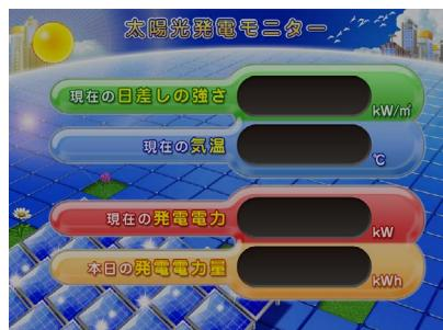
タクトスイッチで発電データ画面に切替え、マウスで画面の右上の時計をクリックします。
