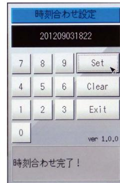
現在の日時を年月日 時 分の12桁で設定します。
