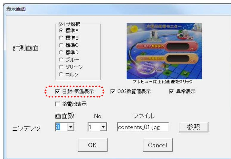
4. サンプル画像をクリックしてプレビュー画面を表示させ、設定した内容を確認します。
