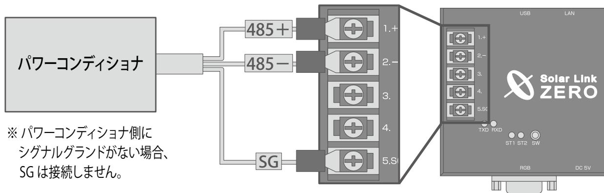
2線式接続の例 (4 線式の場合は、「付 .3 接続する機器の確認 (相手側の機器に合わせる)」P.18 を参照)。
