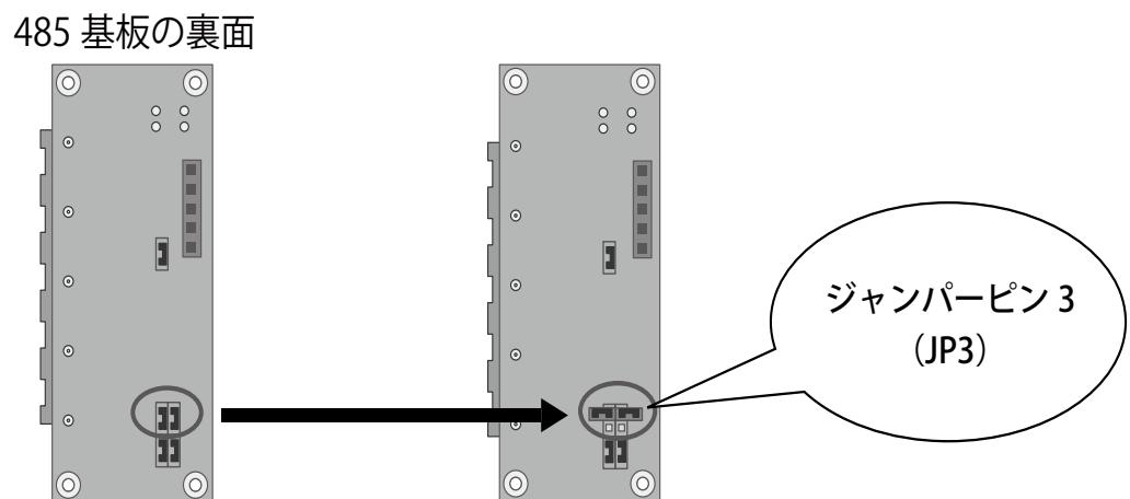
4. 485基板を元に戻します。RGBポートを上にしたとき、Solar Link ZERO本体の内側のピンに485基板を挿し、銀色のネジで取付けます。
