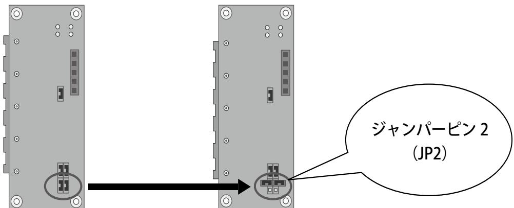
4. 485 基板を元に戻します。RGB ポートを上にしたとき、Solar Link ZERO 本体の内側のピンに 485 基板を挿し、銀色のネジで取付けます。
