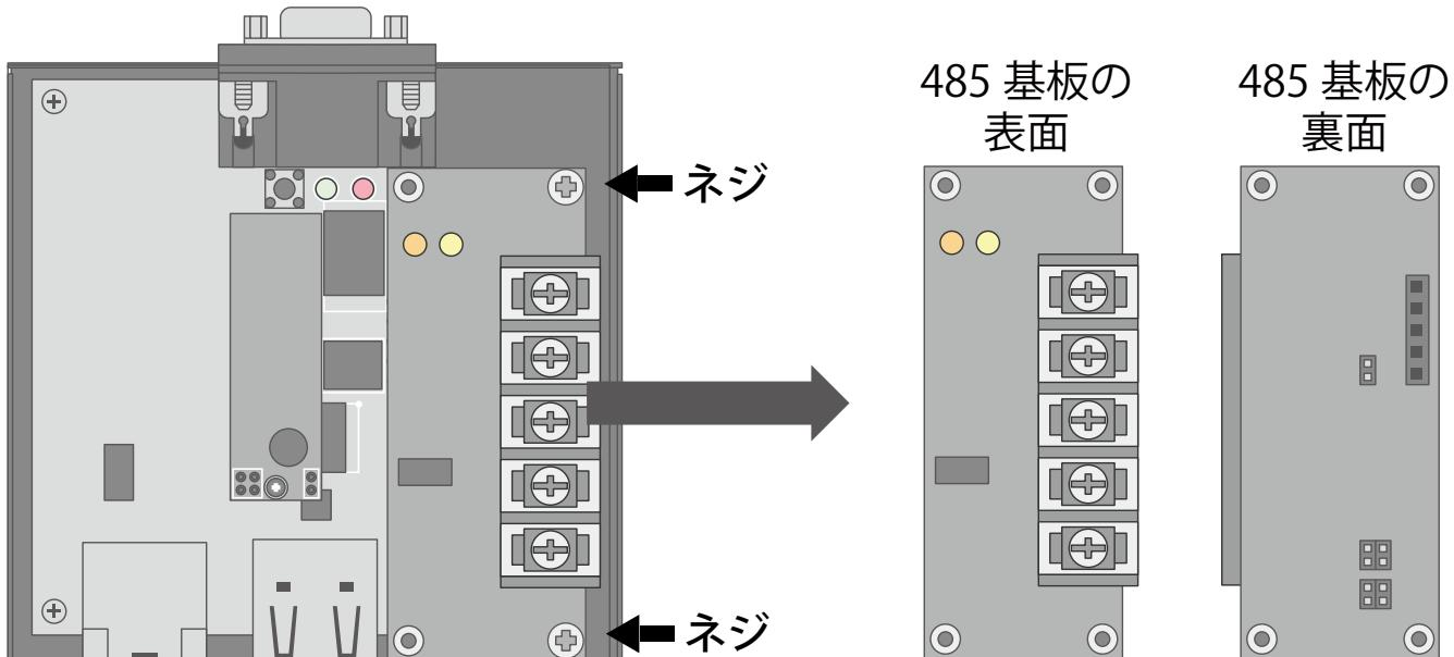
3. 485基板の裏のジャンパーピン3(JP3)を、下図のように挿しかえます。
