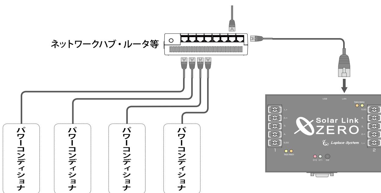
※ パワーコンディショナが1台で、構内 LAN や Web アプリケーションを使用しない場合には、Solar Link ZERO とパワーコンディショナをクロスタイプの LAN ケーブルで直接接続して計測することができます。
