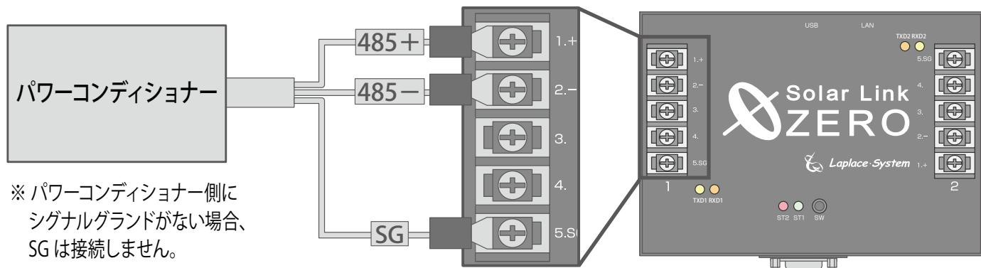
2線式接続の例 (4線式の場合は、「付 .3 接続する機器の確認」 P.18 を参照)。
