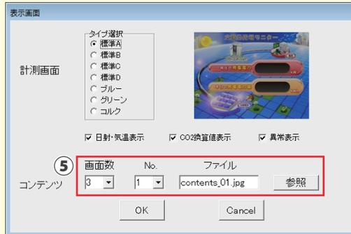
⑤ 【画面数】で表示させたい枚数 (1~5枚) を選択し、【NO.】で数字を選びます。【参照】から表示させたい画面ファイルを選択し、【OK】をクリックして表示画面を閉じます。
