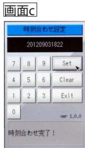
⑥ 入力した時刻に「Set」をクリック。「時刻合わせ完了！」の表示を確認して「Exit」をクリック。次いで「EXIT」をクリック。マウスを Solar Link ZERO 本体から外します。(画面 b の時計設定の表示と現在時刻を確認します)
