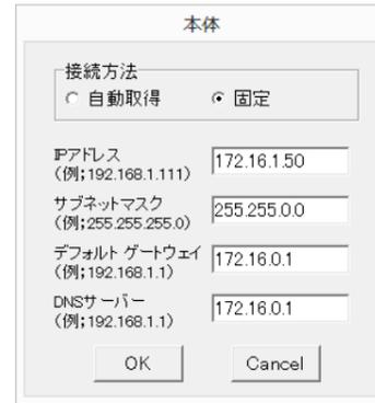
Solar Link ZERO 本体のネットワーク設定の出荷時設定値は IP アドレス出荷時設定表を参照してください。
