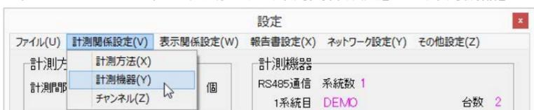
2, 表示された「計測機器」の「TCP/IP 通信」タブを選択し、「IP アドレス」欄の接続台数分の IP アドレスを書き換えます。
