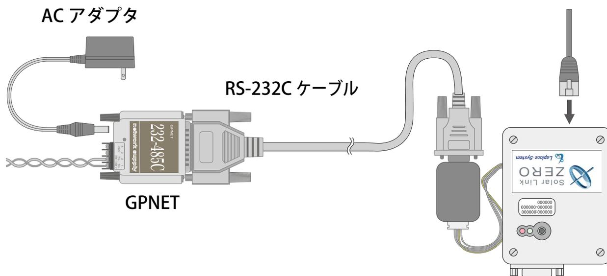
信号変換器の AC アダプタ (DC8V/300mA) を接続し、本体の LED ランプが点灯していることを確認して下さい。
