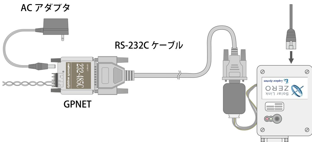
AC アダプタ (DC8V/300mA) を接続し、本体の LED ランプが点灯していることを確認して下さい。
