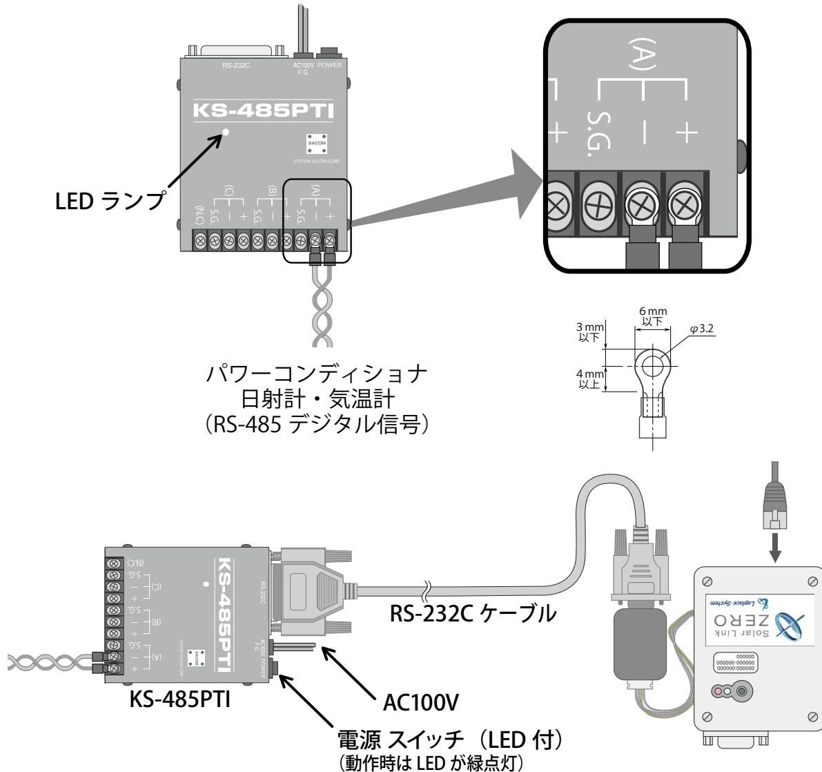
※ 変換器本体の電源スイッチを忘れずに入れてください。電源が入った状態であれば、Power の LED スイッチが緑色点灯します。
