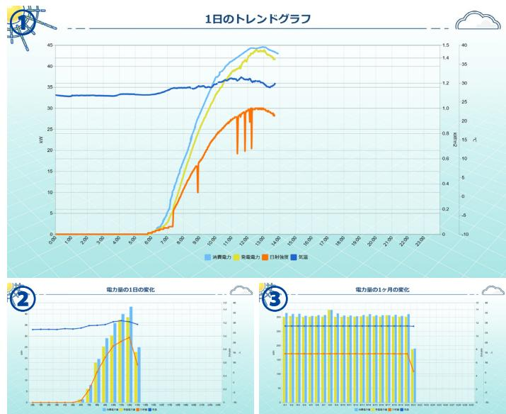
消費電力(量)と発電電力(量)の推移をグラフで確認することができます。グラフは10分毎に更新され、
