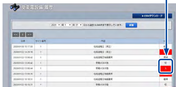
受変電設備履歴画面 ※表示テキストの変更のみ反映されます。
