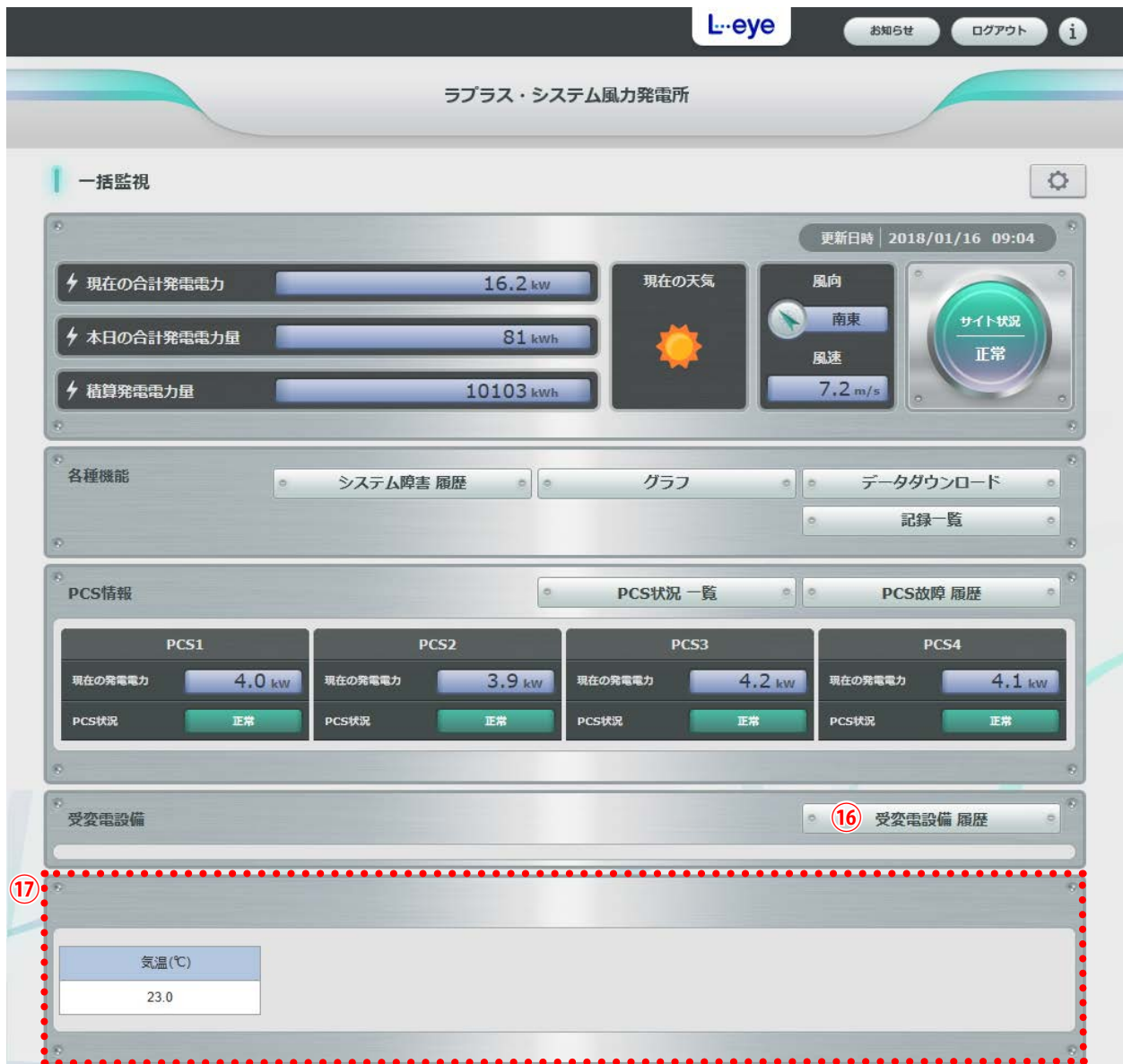
PCS 台数 4 台で、風向計・風速計・気温計の設置・計測が有るサイトの画面例 (「現在の天気」も表示)
