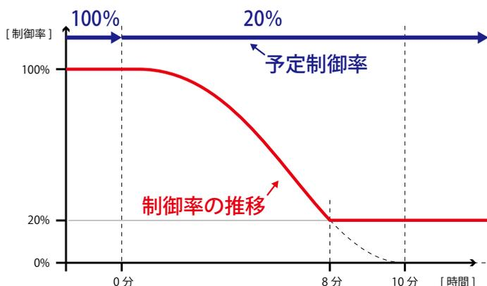
スケジュールにより予定制御率が切り替わるタイミングで、制御機器 (ZERO/PCS) は制御率が一定の速度で変化するように指令を出します (スロープ制御)。
