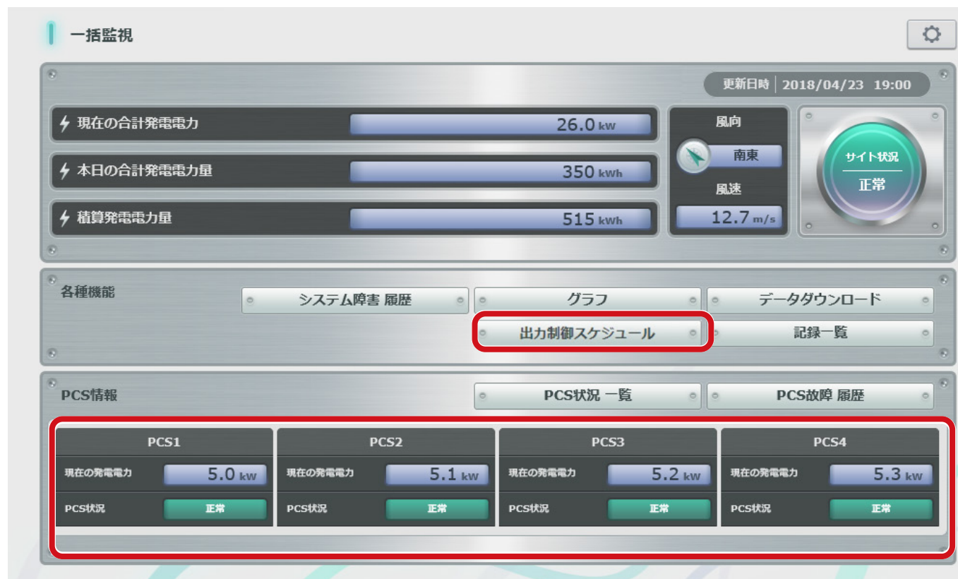
一括監視画面例（「制御率」および「定格比率」の表示欄がない）
