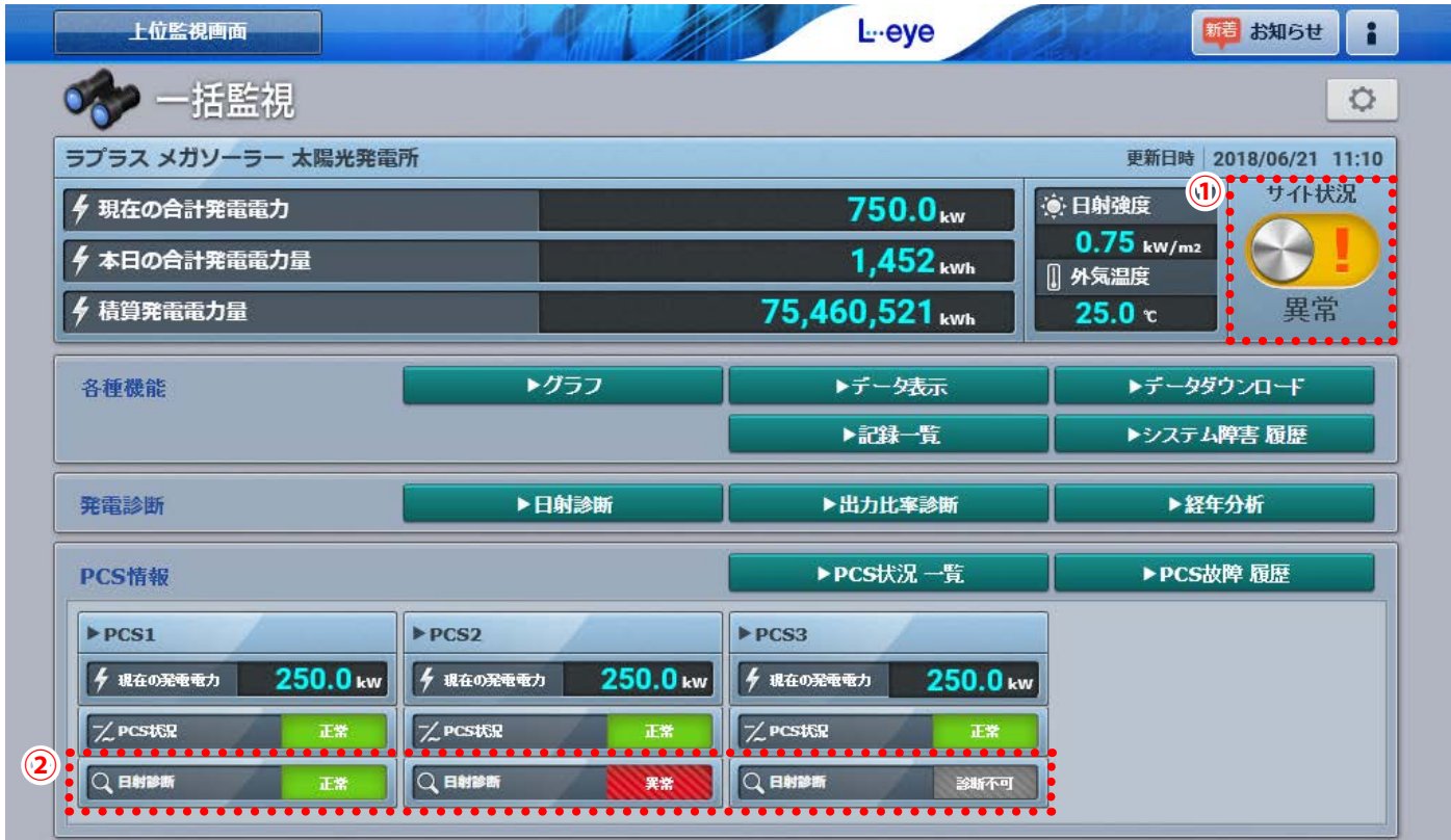
PCS 台数 3 台で、日射強度・外気温度の計測があるサイトの画面例
