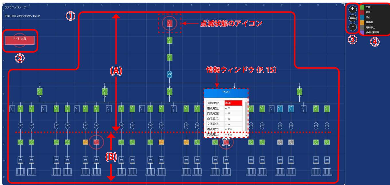
系統連系側の機器（画面上部）から PCS・ストリング（画面下部）へ向かってツリー状に描画された系統図が表示されます。機器のアイコンは JSIA（日本配電制御システム工業会規格）の図記号に準拠しています。
