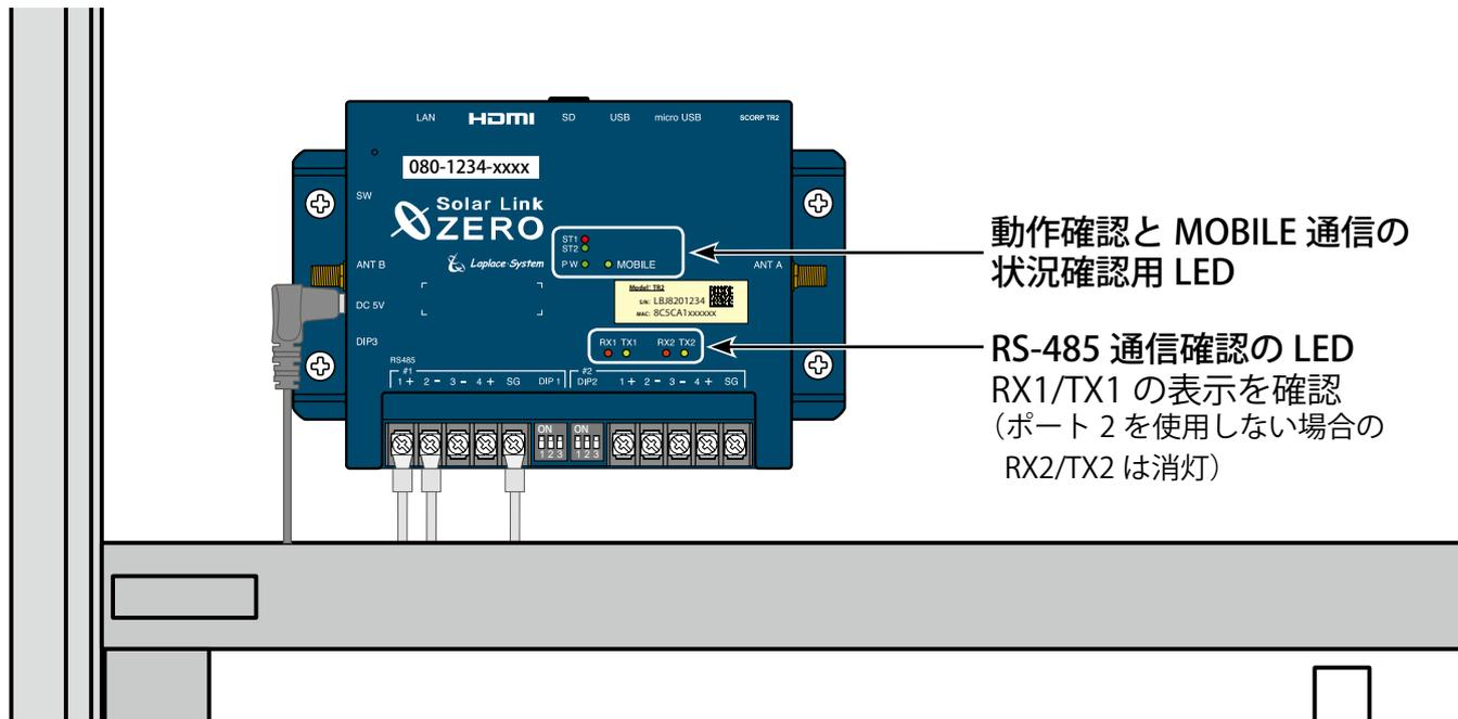
■下表を参考に、計測端末が正常に稼働しているかを確認します。
