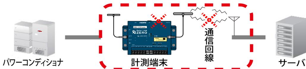
この状況をサーバが判断した場合、一括監視画面の PCS 状況には と表示され、システム障害の更新停止検出発生履歴を残し、通知メールの作成を行います。
