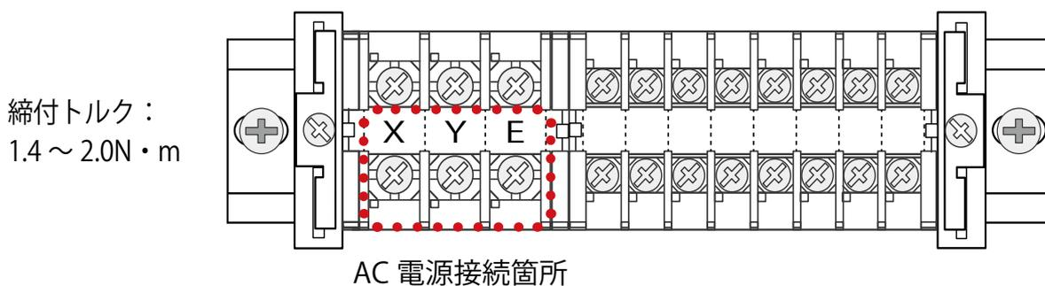
■ 外部からの接地線を、ボックス内の接地端子に接続します。
