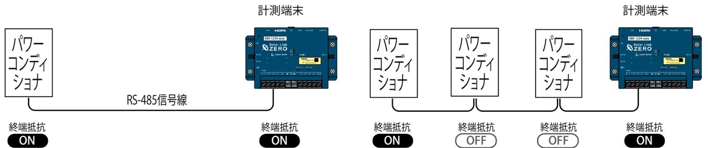
パワーコンディショナの配置などの理由により、計測端末が RS-485 信号線の終端とならない場合には、終端抵抗を OFF にする必要があります。
