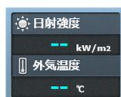
日射計または気温計と、計測端末が通信できていない状態です。
