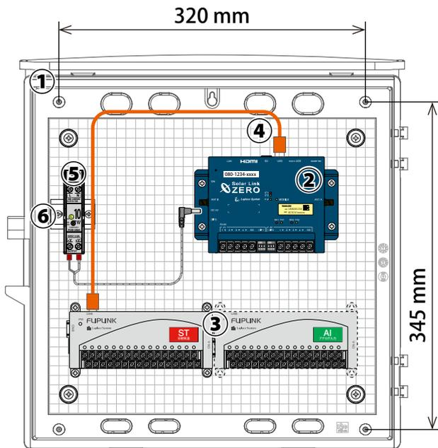
ボックスが LSB-BF03/04 の場合は電源ユニットを上図の様に DIN レールに取り付けます。
