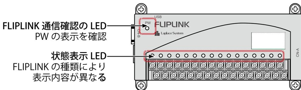
■下表を参考に、FLIPLINK が正常に稼働しているかを確認します。
