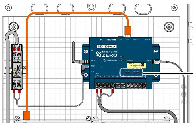
RS-485 通信確認の LED (下図は全て点灯時のイメージ)
