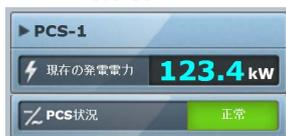
← PCS 毎の現在の発電電力が表示されます [最大 3 桁+小数 1 桁]。
