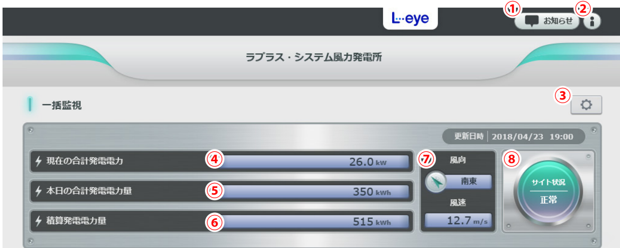
風向計・風速計の設置・計測があるサイトの画面例（風向の矢印アイコンは風下を示す）
